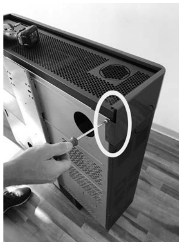
Fig. 35 - Fixar os parafusos
