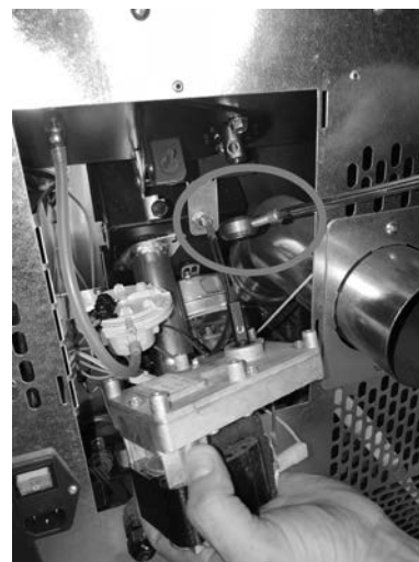
Fig. 51 - Remoção do motorreductor
