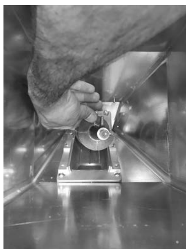
Fig. 52 - Remoção da espiral
