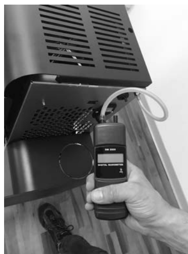
Fig. 48 - Ligação do pressóstato digital
