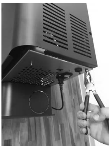
Fig. 47 - Remoção do cárter
